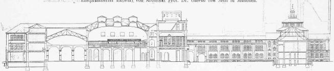
Abb. 4. Längsschnitt von Süd nach Nord durch Mittelhalle, Ehrensaal, Vestibül und Hof. — Masstab 1: 1000.1)
