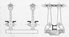
Abb. 11. Zangenbremse der Supergabahn.
