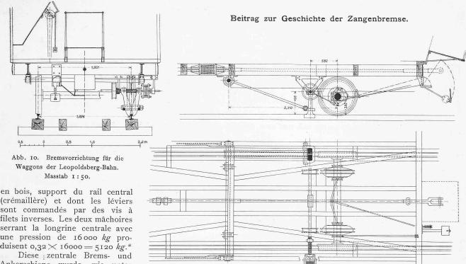
(crémaillère) et dont les léviers sont commandés par des vis à filets inverses. Les deux mâchoires serrant la longrine centrale avec une pression de 16000 kg produisent  $0.32 \times 16000 = 5120 \text{ kg.}^{\circ}$
