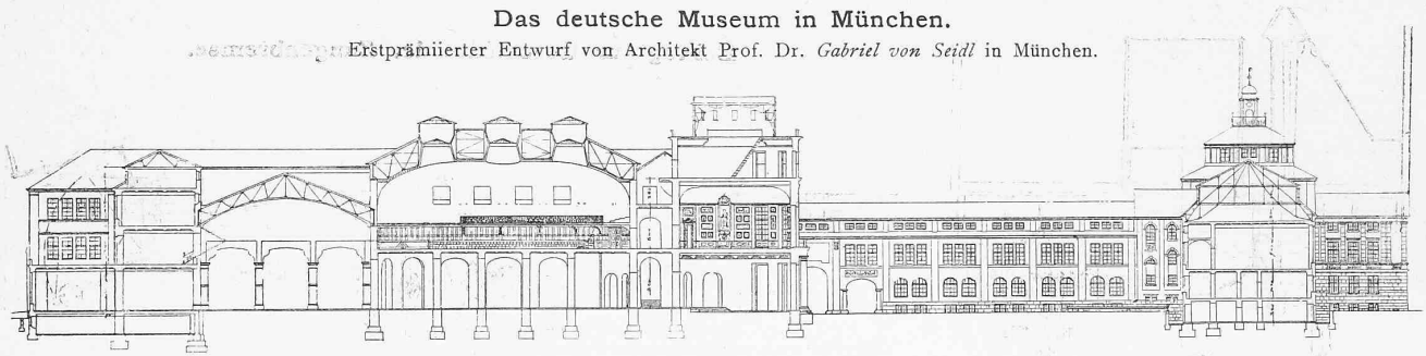
Abb. 4. Längsschnitt von Süd nach Nord durch Mittelhalle, Ehrensaal, Vestibül und Hof. — Masstab 1 : 1000. 1)
