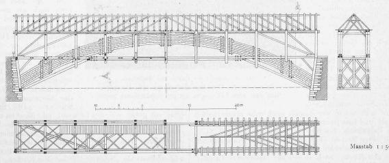
Abb. 3. Grundrisse und Schnitte der ehemaligen Holzbrücke bei Wettingen. — Nach «Plans, coupes et élévations de diverses productions de l'art de charpente exécutées tant en France que dans les pays étrangers, par J. Ch. Krafft, Architecte-Dessinateur, Paris. An XIII, 1805.
