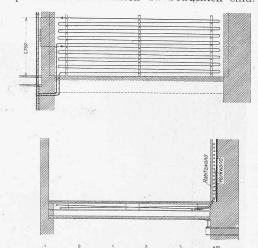
Abb. 8. Boden- und Wandheizung im aseptischen Operationssaal des Kinderspitals in Zürich. Masstab I: 100.
