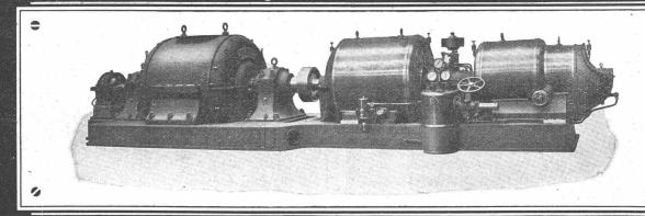
direkt gekuppelt mit Generatoren für Gleiche, Wechsele oder Drehstrom
