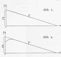
$\gamma = \gamma_0 - n \cdot t$ entsprechend der Abbildung I darstellen kann, wobei mit  $\gamma_0$  die Anfangsbeschleunigung bezeichnet werden möge, während n die die Neigung derBeschleunigungslinie charakterisierende Konstante ist. Der Fall, dass die Beschleunigungslinie eine Kurve
