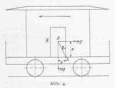
von der konstanten Schwerkraft und  $m \gamma$ , herrührend von der variablen Beschleunigung des in der Richtung des Pfeils anfahrenden Fahrzeugs. Die beiden Kräfte greifen im Schwerpunkte San und bewirken das Eintreten oder die Tendenz zu einer
