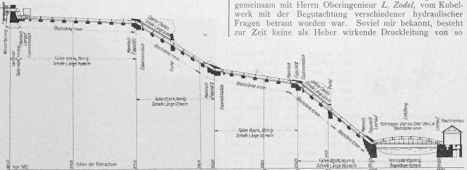
Abb. 1. Längenprofil der zweiten Druckleitung des Elektrizitätswerkes Kubel. — Masstab 1:1500.
