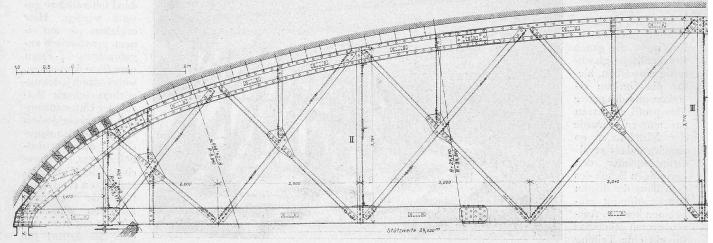
Abb. 30. Eiserner Lehrbogen. - Frontansicht. - Masstab 1:60.
