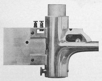
Abb. 3. Hydrometrischer Flügel N. 577. — Kontaktkammer.
