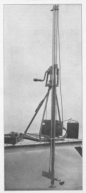
Abb. 4. Hydrometrischer Flügel Nr. 795 mit Halter J. Epper. Ansicht der vollständigen Ausrüstung.
