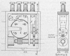
Abb. 8. Kontaktvorrichtung des Flügels Nr. 795. — Masstab I: 2.
