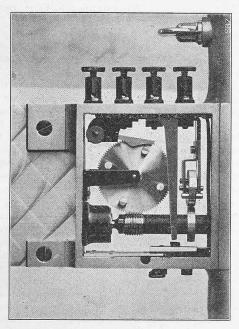
Abb. 6. Kontaktvorrichtung des Flügels Nr. 795.
