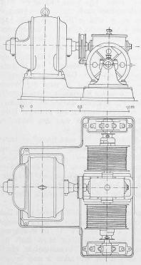
Abb. 9. Das Windwerk des elektrischen Krans auf dem Lastdampfer «Venoge». — 1:25.
