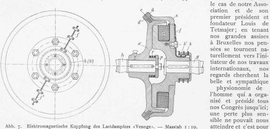
Abb. 7. Elektromagnetische Kupplung des Lastdampfers «Venoge». — Masstab 1:10.
