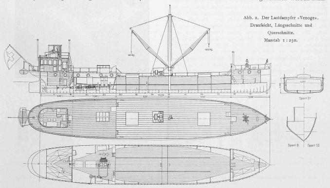
Die Raumeinteilung des Schiffes (Abb. 2) zeigt am Bug die Kabine für Kapitän und Maschinist; den Hauptteil nimmt der Laderaum ein mit einer Länge von 17,5 m, hinter dem der Maschinenraum folgt. Im hintersten Teil befinden sich die Schlafstellen der Matrosen. Dort besitzt das Deck einen Aufbau, der das Esszimmer, die Küche, das Bureau des Kapitäns und das Klosett enthält.
