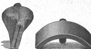
Baggermaschinen für Nass- und Trockenbaggerung. Baggerlöffel.
