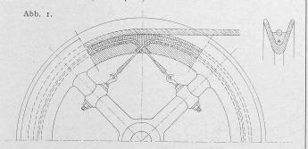
Vorteilhafter ist die Ausfütterung mit Lederabschnitten. Die innern Ränder der Scheibe werden unterschnitten, damit die entsprechend geformten Lederabschnitte festhalten. Zur Verwendung kommt altes, durchfettetes Riemenleder; wenn neues Leder benützt werden soll, muss dasselbe durch
