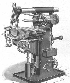
Einfache Fräsmaschine. No. 2.
