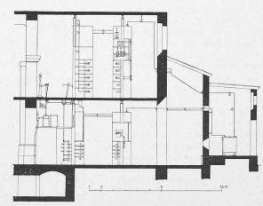
Abb. 57. Querschnitt durch die Schaltanlage und den Transformatorenraum des Kraftwerkes Obermatt bei den Generatoren-Umschaltern. — 1:250.
