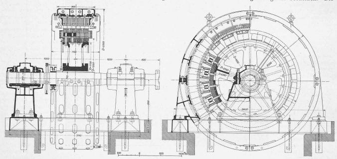
Abb. 54. Drehstromgenerater von 2000 P.S. Leistung in dem Kraftwerk Obermatt. — Erbaut von der Maschinenfabrik Oerlikon.
