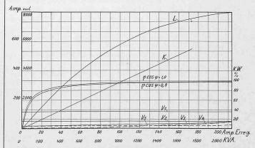
Abb. 55. Charakterist. Kurven des Drehstrom Generåtors von 2000 P.S. Legende: L Leerlaufcharakteristik, K Kurzschlusscharakteristik,  $\eta$  Wirkungsgrade,  $V_1$  Verluste durch Hysteresis und Wirbelströme im Armatureisen,  $V_2$  Verluste durch Reibung und Ventilation,  $V_3$  bis  $V_5$  Verluste durch Ohmschen Widerstand:  $V_3$  in den Feldspulen bei cos  $\varphi=$  0,8.
