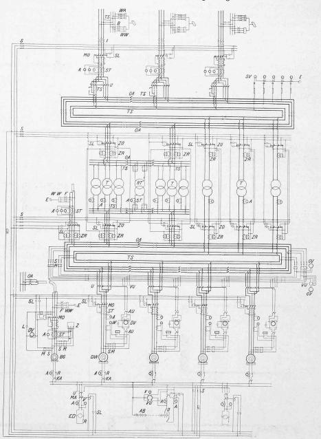
Abb. 59. Schaltungsschema des Kraftwerkes Obermatt.
