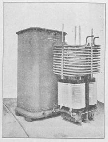
Abb. 65. Einphasentransformator für 700 KVA.
