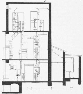
Abb. 58. Querschnitt durch die Mitte der Schaltanlage des Kraftwerkes Obermatt, den Turm sowie die Erregerzellen. -
