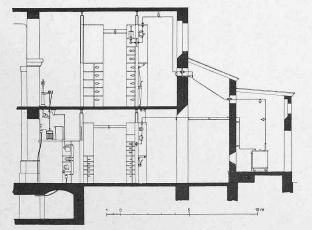
Abb. 56. Querschnitt durch die Schaltanlage und den Transformatorenraum des Kraftwerkes Obermatt bei den Generatoren-Schaltern. - 1:250.
