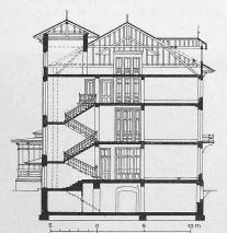
Abb. 8. Querschnitt durch das Hauptgebäude. Masstab 1:400.
