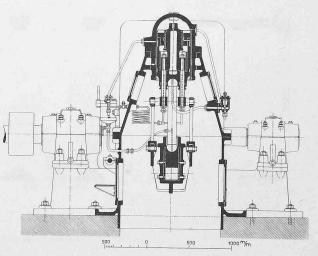
Abb. 46. Querschnitt durch Freilaufsteuerung (Patent Nr. 29862) und Einlauf.
