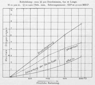
gering, dass es namentlich bei Anlagen von dieser Grösse nicht in Betracht fällt. Der Wirkungsgrad des Freilaufapparates (Druckregulierung) beträgt 95 %. Die Schlusszeit des automatischen Geschwindigkeits-Regulators wurde auf 2 bis 2½. Sekunden reduziert. In dieser kurzen Zeit können 2500 P. S., d. h. die Vollast einer Turbine ohne wesentliche Störung des normalen Zustandes der Wassersäule und der Geschwindigkeit ausgeschaltet werden.
