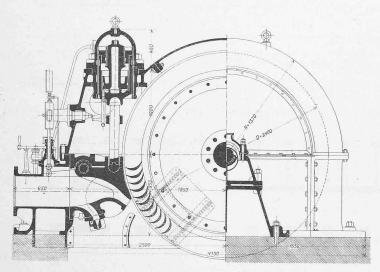
Abb. 43. Längsschnitt durch Einlauf und Turbine.
