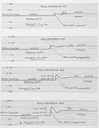
Abb. 52. Geschwindigkeitsdiagramme der 2500 P. S. Hochdruckturbine.
