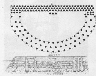
Abb. 17 u. 18. Fundierung des Creuzot-Pavillons im Jahre 1900 am Seineufer, nach dem System «Dulac». — 1:200.
