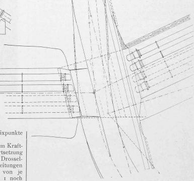
Abb. 26. Druckleitung bei Fixpunkt SIII und Unterfahrung der Strasse nach Engelberg. — Lageplan. — Masstab I: 250.
