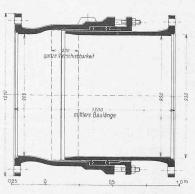
Abb. 31. Expansionsmuffe. Ausgeführt von Gebrüder Sulzer in Winterthur. — 1:25.
