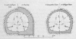
Abb. 14. Normalprofile des Zulaufstollens. — Masstab 1:100.
