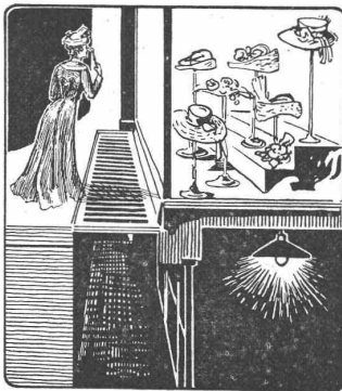
Offene Roste sind hygienisch von Nachteil und begünstigen Raumverschwendung und Feuersgefahr.
