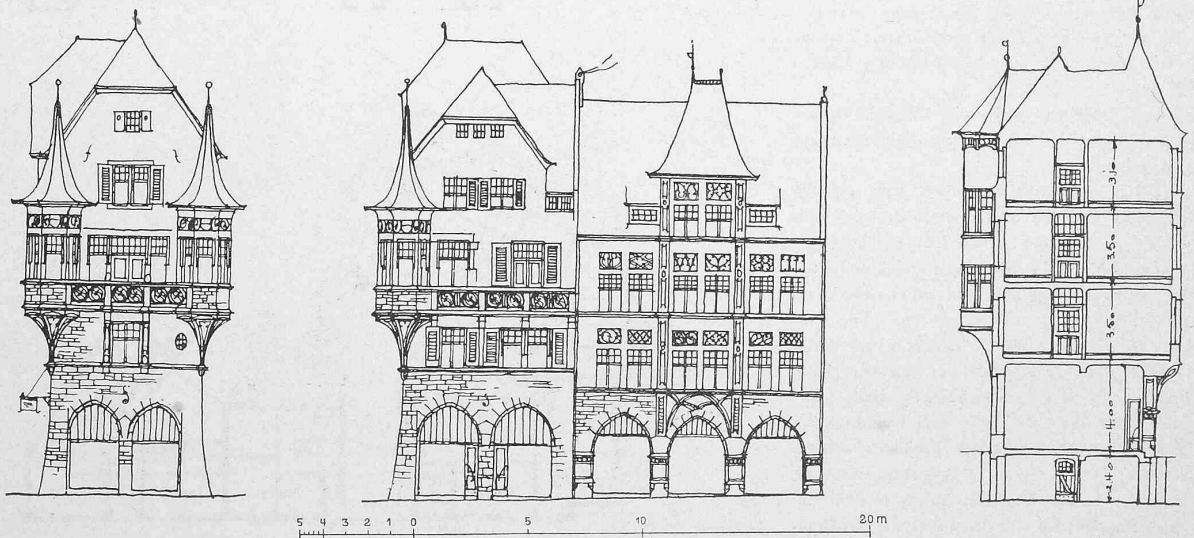
Geometrische Ansicht der Nordfassaden an der Avenue de la Gare. — Masstab 1:300. — Schnitt durch den Nordflügel.
