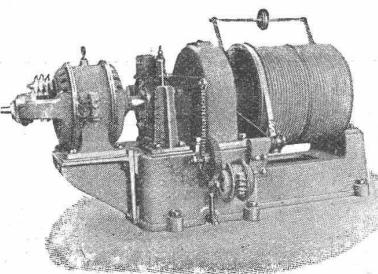
mit automatisch-elektrischer Druckknopfsteuerung
