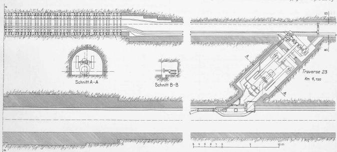
Abb. 57. Kühlanlage. — Wasserfassung in Trav. 21 a. Presswasserbeschaffung durch Trav. 21 b mit Pumpenanlage in Trav. 23. — 1:300.
