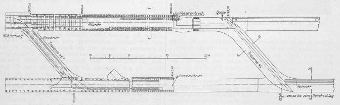
Abb. 58 a. Einbau, Wasserführung und Ventilation in Stollen I und Stollen II, vorwärts Traverse 45 a.
