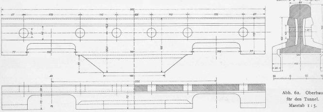
Die Legung des endgiltigen Oberbaues (Abb. 62), auf der Nordseite schon früher beendigt, fand auf der Südseite im Laufe des Januar 1906 statt. Am 25. Januar morgens überschritt der Schienenstrang das Südportal (Abb. 63). Unmittelbar darauf durchfuhr die erste normalspurige Lokomotive mit einigen Personenwagen den Tunnel und brachte die Mitglieder der Kreisdirektion I der S.B.B. aus der Schweiz nach Iselle (Abb. 64).
