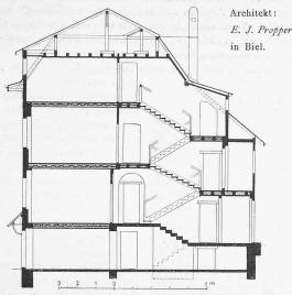
Abb. 8. Querschnitt a-a durch das Haus I. - Masstab I: 200.
