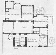
Abb. 3. Villa Castenholz in Koblenz. — Grundrisse vom Erdgeschoss und I. Obergeschoss. Masstab I: 400. — Architekt Willy Bock in Koblenz.
