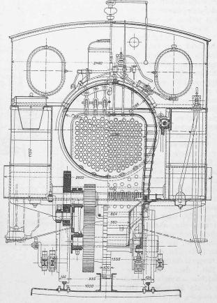
Abb. 4. Querschnitte durch die Lokomotive. — Masstab 1:30.
