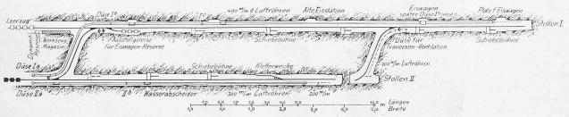
Abb. 8. Vortrieb-Installation im Tunnnel. — Anordnung der Luftleitungen, Strahldüsen, Ausstellungsgleise usw.
