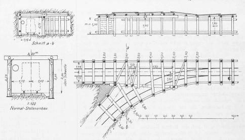
Abb. 5 a. Einbau für Gewölbe in gebrächem Gebirge. — Masstab 1:200.
