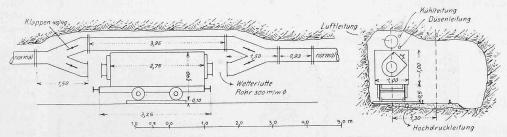
Abb. 9. Hülfsstation mit Eiswagen im Stollen I. — Masstab 1:100.
