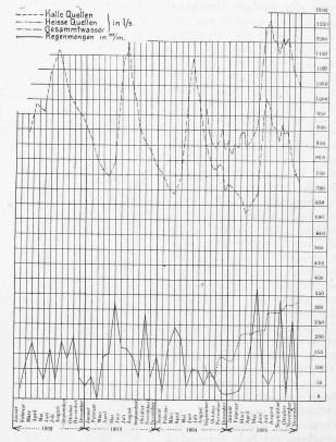
Abb. 3. Diagramm der auf der Südseite aus dem Simplontunnel abfliessenden Gebirgswassermenge sowie der Regenmenge in Iselle.
