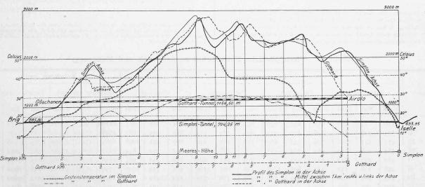
Abb. 6. Vergleichende Darstellung der Längenprofile und der Gesteinstemperaturen des Simplon- und des Gotthardtunnels.
