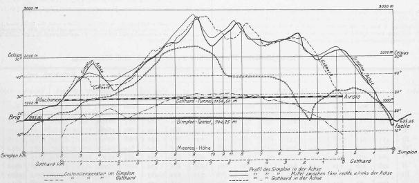
Abb. 6. Vergleichende Darstellung der Längenprofile und der Gesteinstemperaturen des Simplon- und des Gotthardtunnels. Masstab 1:125000 für die Längen, 1:50000 für die Höhen.
