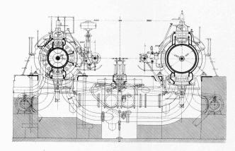
Die liegende Dreifachexpansionsmaschine von 6000 P. Se Leistung
