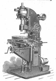
Vertikal-Fräsmaschine, No. 2.
