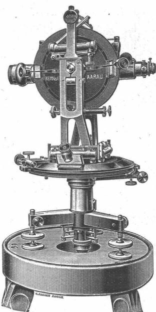
**Patente:** **Zirkelkopf**, bei welchem Feststecken der Axe und toter Gang ausgeschlossen.
