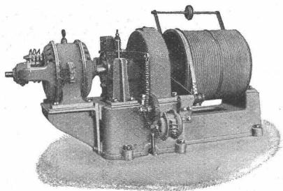
mit automatisch-elektrischer Druckknopfsteuerung
