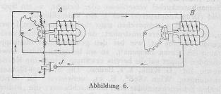
vom untern angezogen, die obere Schneide verlässt den Rechen, er bewegt sich um ein Stück abwärts, bis er durch die untere Schneide aufgehalten wird. Inzwischen hat sich der Induktor um 180 gedreht, es geht ein — Impuls in die untere Schneide, der Anker bewegt sich von
