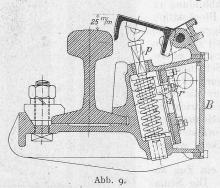
der Rücken des U-Eisens am äussersten Ende mit der Schienenoberkante in eine horizontale Ebene zu liegen kommt (Abb. 10 a). Es wird nun die Kontaktvorrichtung in der Weise betätigt, dass der Radkranz des Fahrzeuges das U-Eisen niederdrückt, wobei die eigentümliche Form der beiden Enden und die Detailanordnung (Abb. 9) ein möglichst stossfreies Arbeiten ermöglicht. Das eine der
