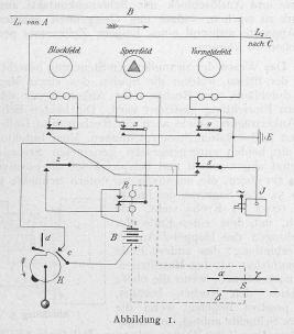
In Abbildung I ist eine Blockstation dargestellt, wobei diejenigen Teile, die für die entgegengesetzte (—) Fahrtrichtung in Frage kommen, weggelassen sind. Der vollständige Apparat würde also sechs Felder enthalten. Fürjede Richtung ist erforderlich: I. Ein Blockfeld, das die Semaphorenkurbel verschliesst oder freigibt, 2. ein Sperrfeld (Druckknopfsperre) und 3. ein Vormeldefeld.
