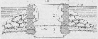
Abb. 12. Vorgang beim Fundamentabbruch der Pfeiler der alten Rheinbrücke.
