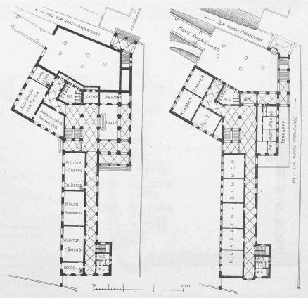
Grundrisse vom Untergeschoss und Erdgeschoss. - Masstab 1:800.
