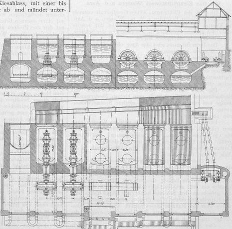
Abb. 4. Das Maschinenhaus. — Grundriss und Längssehnitt. — Masstab 1:500.
