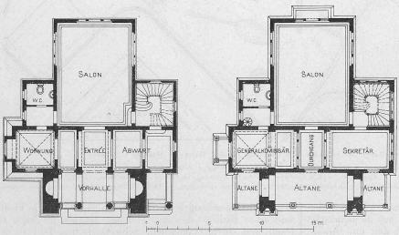
Abb. 5. Grundrisse vom Erdgeschoss und Obergeschoss. — Masstab 1:300.
