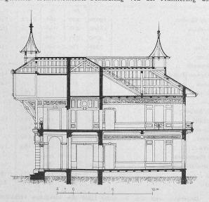
Abb. 6. Schnitt in der Längsachse. — 1:300.
