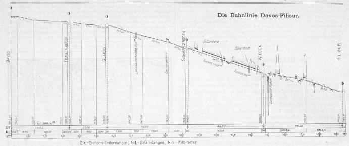
Abb. 2. Generelles Längenprofil. — Masstab I: 100 000 für die Längen, I: 10 000 für die Höhen.
