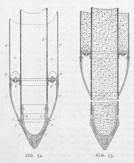
cher eiserner Pfähle pyramidal gegen einander geneigt eingerammt, über Hochwasserhöhe abgeschnitten und mit einer eisernen Platte abgebunden, auf welche dann die Eisenkonstruktion der Joche aufgesetzt wurde.
