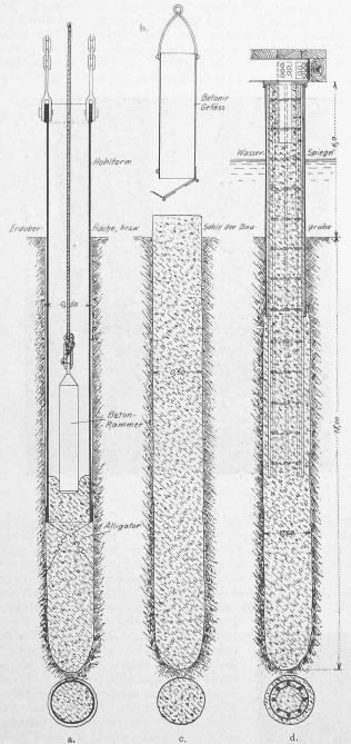
Abb. 44. Mit dem Alligator-Pfahlschuh erstellte Betonpfähle. Masstab I:40.
