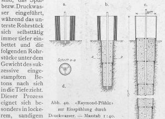
sand und Schlamm, die sich leicht durch das Spülwasser lösen und sich durch dessen Druck auf der äussern Seite der Pfahlhülse nach oben treiben lassen. schlammigen Ufer des Missouri in Omaha (Nebraska) wurde demonstrationsweise eine solche Hülse mit einem obern und untern Durchmesser von 50 cm, bezw. 25 cm mit Wasser unter etwa 2,8 Atm. Druck in kürzester Zeit 22 m tief in den Boden
