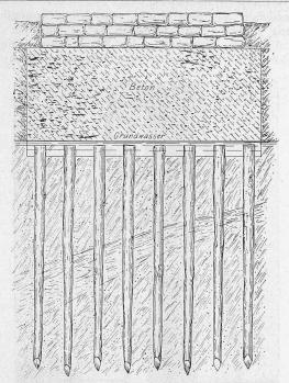
Abb. 30. Brückenwiderlager auf Holzpfählen.
