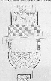
namentlich die Querschnittsfläche sowie der Rauhig-keitsgrad der Aussenfläche den gewöhnlich erhältlichen Holzpfählen gegenüber bedeutend gesteigert werden. Damit ist es möglich, die seitliche Kompression des den Pfahl umgebenden Grundes, dessen Reibungswiderstand sowie die horizontale
