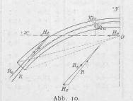
Das Einzeichnen der tatsächlichen Stützlinie ist also für die Ermittlung der Randspannungen nicht nötig, würde auch nicht zu dem genauen Ergebnis führen, wie die Rechnung. Will man den Verlauf der tatsächlichen Stützlinie zeichnen, so hat man die Kräfte der mittlern Stützlinie mit der Ergänzungs-
