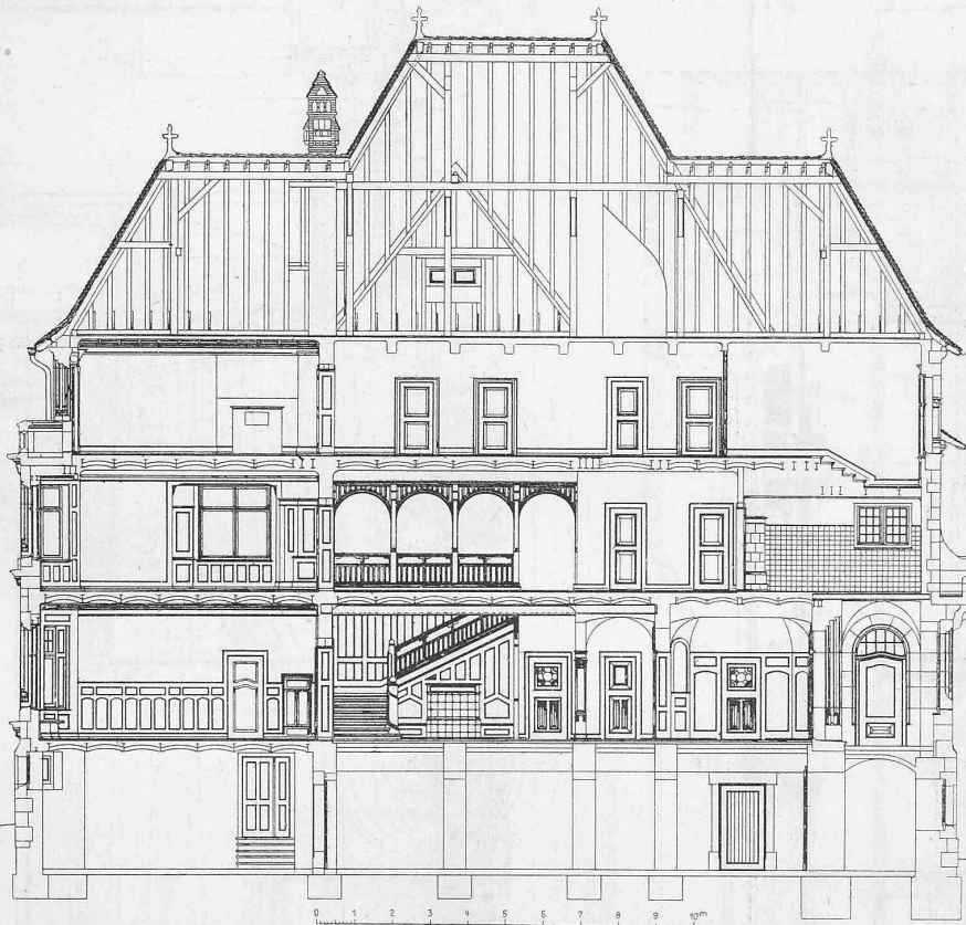
Abb. 7. Längsschnitt durch die Halle. — Masstab 1 : 200.
