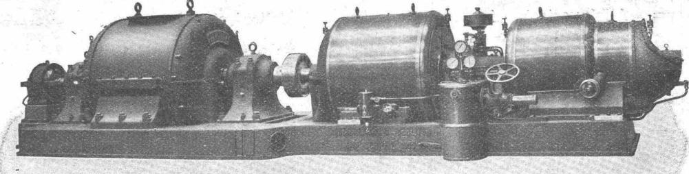
direkt gekuppelt mit Generatoren für Gleich-, Wechsel- oder Drehstrom
