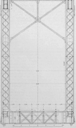
Abb. 23. Querschnitt in der Brückenmitte. — Masstab I: 100.
