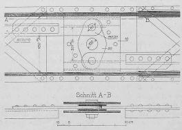
Abb. 25. Gelenk der Zugstangen. — Masstab 1:20.
