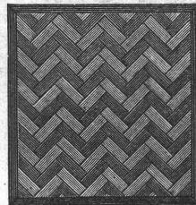
**Auf Blindboden aufgeschraubt; auf Zementbeton in Mörtel verlegt.**
