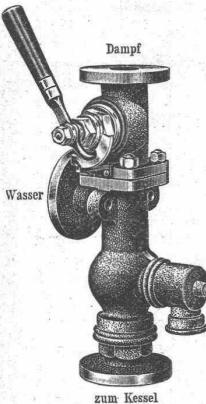
Beste u. einfachste Spei-sevorrichtung für statio-näre Kessel und Loko-motiven. Unempfindlich gegen Stöße u. Eintre-ten von Luft in die Saugeleitung.
