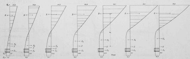
Abb. 7. Spannungsverteilung im rechteckigen Querschnitt  $^{15}/_{30}$  cm mit  $F_e=2$   $\oplus$  22 mm oder  $^{1}$ ,9 $^{0}/_{0}$  Armierung.
