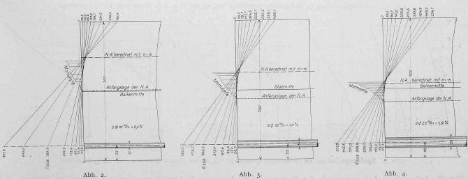
Je sechs Körper waren mit 2  $\oplus$  10 mm, bezw. 2  $\oplus$  16 mm und 2  $\oplus$  22 mm armiert und hiervon dienten jedesmal drei für die Messung der Eisendehnungen und drei für die Ermittlung der Verkürzungen der obersten Betonfasser, weil die
