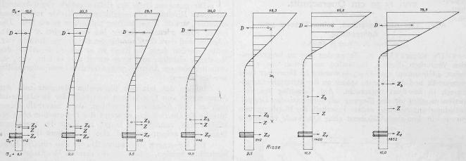
Abb. 5. Spannungsverteilung im rechteckigen Querschnitt  $^{15}/_{30}$  cm mit  $F_{\ell} = 2 \oplus 10$  mm oder  $0,4^{0}/_{0}$  Armierung.
