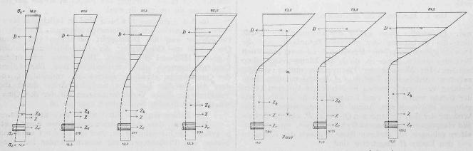
Abb. 6. Spannungsverteilung im rechteckigen Querschnitt 15/30 cm mit Fe = 2 \( \Dagger 16 mm oder 1,0 0/0 Armierung.
